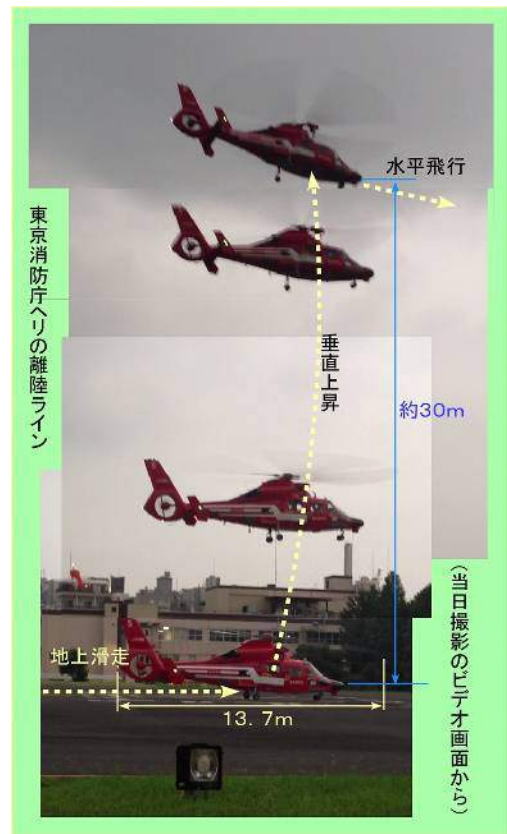
記録ビデオ合成画面から分析した消防庁ヘリの離陸時軌跡と高度
